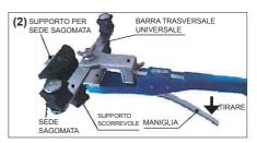
Inserire la matrice di dimensioni corrette nel supporto per la sede sagomata, quindi posizionare la barra trasversale sul relativo supporto e serrare con la vite a farfalla.
