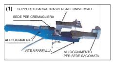
Fissare il supporto per la sede sagomata ed il supporto della barra trasversale universale sull'alloggiamento della piegatrice.
