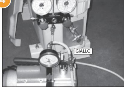
Collegare il tubo flessibile giallo dalla parte del rubinetto a sfera all'attacco della pompa del vuoto. Collegare l'altro capo del tubo flessibile giallo all'attacco di carica (centrale) del gruppo monometrico.
