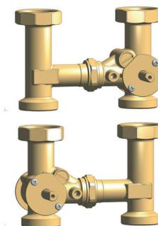
6) Assemblare il gruppo nella nuova disposizione con pompa a Sx come indicato in figura. Serrare tutte le calotte utilizzando chiavi idonee e facendo molta attenzione al corretto posizionamento delle guarnizioni.
