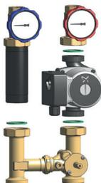
3) Invertire la posizione delle due valvole di intercettazione ROSSA/BLU e del tronchetto in acciaio collegato con la valvola BLU.
