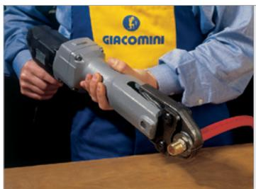
Avviare la pressatrice ed attendere la completa chiusura delle pinze cui corrisponde il bloccaggio del raccordo. Durante questa operazione prestare particolare attenzione ai meccanismi in movimento onde evitare fortuiti incidenti.
