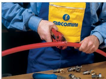
Tagliare il tubo perpendicolarmente al proprio asse, utilizzando una cesoia, (si consiglia di ruotare leggermente la cesoia durante l'operazione), oppure la tagliatubi a rotella, al fine di limitare l'ovalizzazione del tubo stesso.
