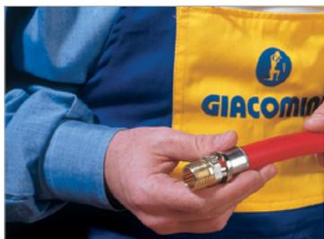
Inserire il tubo a fondo nel raccordo; la corretta posizione di accoppiamento è segnalata dalla visibilità della tubazione attraverso le fessure dell'anello ferma bussola. La forma a terminale svasato della bussola, inoltre, facilita l'inserimento del tubo.
