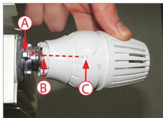
**2)** Agganciare la testa termostatica alla valvola, verificando che piolo della valvola (A), feritoia piccola della testa termostatica (B), simbolo Keymark (C), siano allineati.
