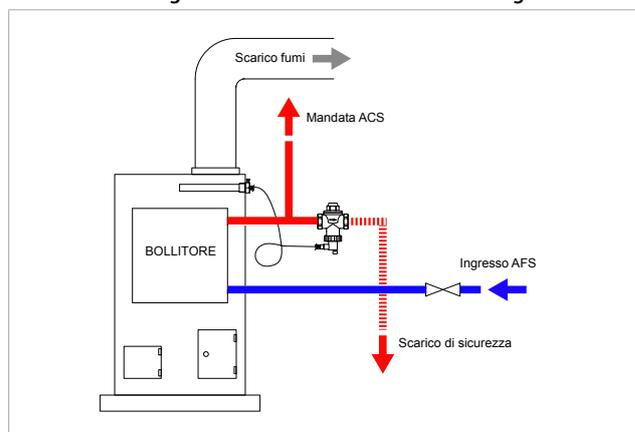
Al raggiungimento della temperatura di taratura, la valvola R144ST si apre scaricando l'acqua calda contenuta nel bollitore integrato della caldaia per abbassarne la temperatura.
