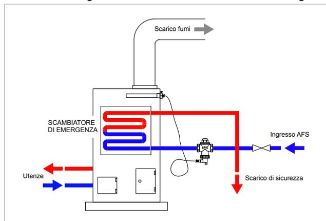
Al raggiungimento della temperatura di taratura, la valvola R144ST si apre facendo circolare acqua fredda nello scambiatore di sicurezza del generatore per abbassarne la temperatura.
