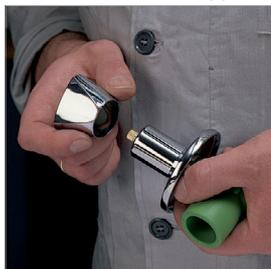
Le operazioni vengono completate spingendo in battuta contro il rivestimento il rosone cromato ed inserendo sul cielo del volantino nell'apposita sede il segnalatore di colore azzurro per montaggi su linee di acqua fredda o di colore rosso per linee di acqua calda. Nel caso si debba sostituire il vitone del rubinetto di arresto danneggiatosi nel funzionamento è disponibile il ricambio
