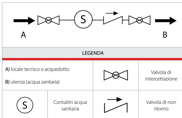
Figura 5 – Schema di funzionamento
