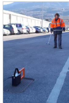
LOCALIZZAZIONE TUBAZIONI E CAVI INTERRATI CON METODO PASSIVO, ATTIVO GALVANICO ED ATTIVO INDUTTIVO
