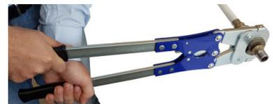
**Avvertenza importante** : La pinza è dotata di un cricchetto antiritorno che non ne permette la riapertura fino a che la pressatura non sia completa.
