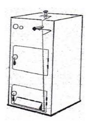
Il regolatore di tiraggio, controllando automaticamente l'aria comburente, modula l'intensità del fuoco alla richiesta dell'impianto realizzando così una temperatura ambiente confortevole e una sensibile economia di combustibile.
