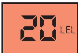
Il display con colore rosso, rappresenta una concentrazione di gas Esplosivo in% del LEL (L.I.E.) superiore ad una delle soglie di allarme
