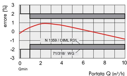
L'impiego di materiali di alta qualità e l'accurata taratura effettuata su ogni singolo misuratore, rendono la curva d'errore stabile nel tempo.
