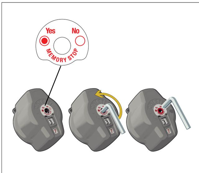
Sulla manopola sono ricavati due fori con i quali è possibile piombare (5) la posizione di taratura per evitare o rilevare eventuali manomissioni nel tempo.
