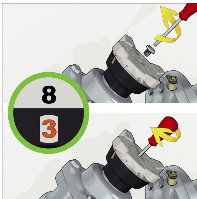
Per le misure DN 200÷DN 300, la vite interna a brugola (esagono 6 mm) del "memory stop" si trova sotto il tappo di protezione centrale.
