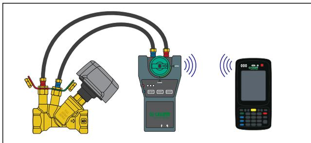
Il terminale fornito in confezione è già dotato del software Caleffi Balance sul quale sono caricati tutti i dati relativi alle valvole di bilanciamento Caleffi e alle principali valvole di bilanciamento disponibili in commercio. Il dispositivo consente di effettuare le misurazioni secondo i metodi descritti in precedenza, di visualizzare i risultati e di effettuarne il salvataggio.
