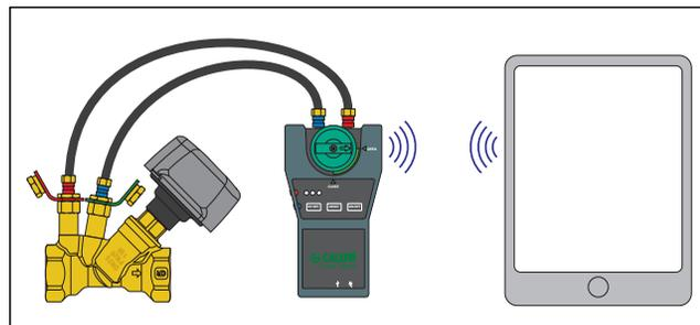
Seguendo la procedura riportata in confezione è possibile scaricare sul proprio terminale dotato di sistema operativo Android® (Smartphone o Tablet), l'applicativo Caleffi Balance. Esso include tutti i dati relativi alle valvole di bilanciamento Caleffi e alle principali valvole di bilanciamento disponibili in commercio.
