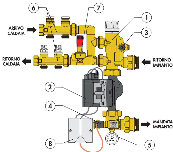
Collettore di ritorno dotato di valvole di intercettazione.
