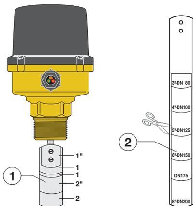
Il flussostato va preferibilmente installato sulla tubazione con asta di comando in posizione verticale, attenendosi al senso del flusso indicato dalla freccia posta sul coperchio e sulla parte esterna del corpo.
