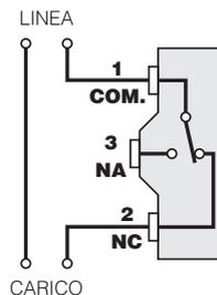
Flussostato utilizzato per attivare un dispositivo in **presenza di flusso**
