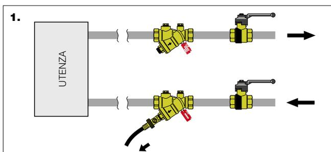
2. Effettuando un flussaggio inverso (il flusso d'acqua investe in senso opposto il filtro). Si chiude la valvola di intercettazione sulla mandata prima di aprire la valvola di scarico.
