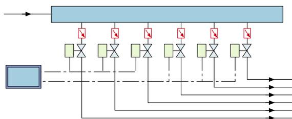
Per controllare la quantità d'acqua erogata e bilanciare i vari circuiti negli impianti d'irrigazione.
