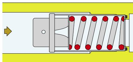
In questo campo di lavoro, il pistone comprime completamente la molla e lascia solo l'apertura a geometria fissa come via di passaggio per il fluido.
