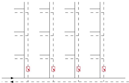
Per regolare la portata che fluisce in ogni colonna o in ogni derivazione secondaria di un impianto.
