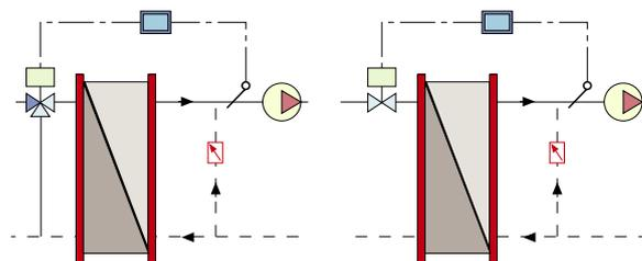
Per realizzare by-pass di equilibratura delle portate negli scambiatori di calore.
