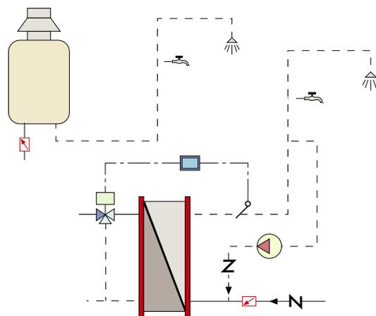
Per limitare la portata d'acqua calda erogabile nei sistemi a produzione istantanea o con limitate capacità.
