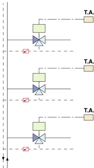
Per garantire le portate di progetto (sia a valvola aperta, sia a valvola chiusa) alle varie zone di un impianto.
