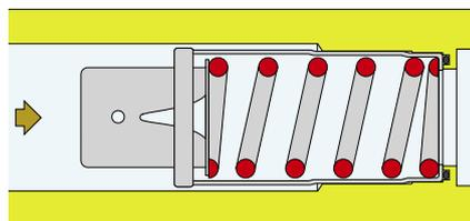
Se la pressione differenziale è compresa nel campo di lavoro, il pistone comprime la molla ed offre al fluido una sezione di libero passaggio tale da consentire il regolare flusso della **portata nominale** per cui l'AUTOFLOW® è abilitato.
